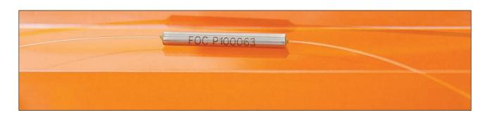
Faser-Durchmesser-Konverter (FDCs) sind spezielle Multimodepatchkabel, die es erlauben, z.B. Sendebauelemente mit 62,5  $\mu$ m-Faserpigtailausgang reflexionsfrei mit 50  $\mu$ m Glasfasernetzen zu nutzen.
